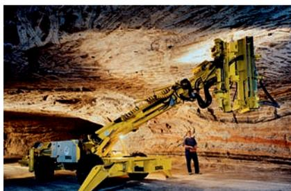
Firstanker-Bohrwagen, der im Grubenbau eingesetzt wird.
